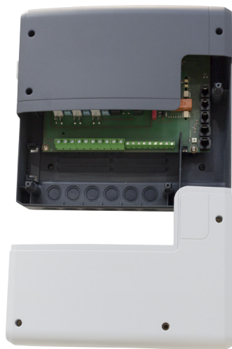
Leistungsteil, Unterteil der Frontabdeckung geöffnet
